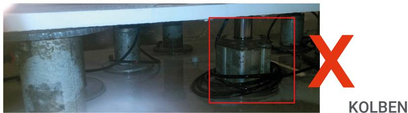
Die Saugköpfe müssen auf geeignete Weise verteilt werden, um die Bereiche der Platte zu halten, die bei der Bearbeitung am stärksten belastet werden. Es müssen Saugköpfe verwendet werden, die sich auch für das Erfassen schmaler Bereiche eignen (siehe Abbildung).
