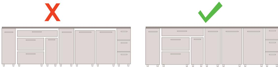
Para las encimeras de 12 mm de espesor, se aconseja preparar un soporte total distribuido por toda la superficie de la pieza elaborada, para darle mayor estabilidad. Por lo tanto, utilice contrachapado marino con un espesor mínimo de 20 mm que soporte completamente la encimera.
