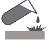
Resistencia a ácidos y bases                                                                                                                                          | EN 14617-10 | C4 - Resistente                                                          |
