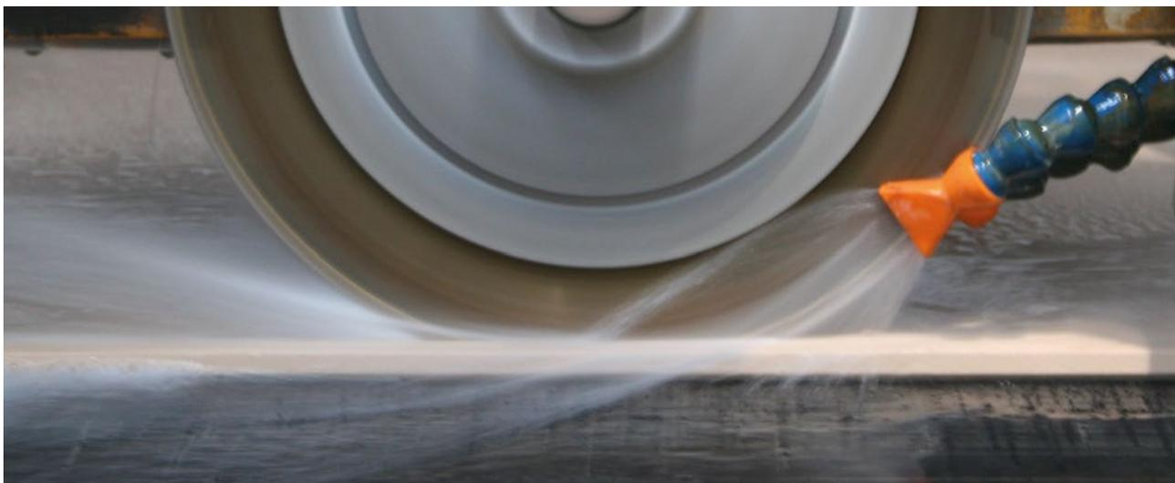
Assicurarsi che il banco della fresa sia in buono stato e planare. Qualora il banco non fosse in buone condizioni si suggerisce di interporre un tappeto in gomma tecnica ad alta densità tra il materiale e il banco della fresa, riducendo le vibrazioni e migliorando la finitura del taglio.
