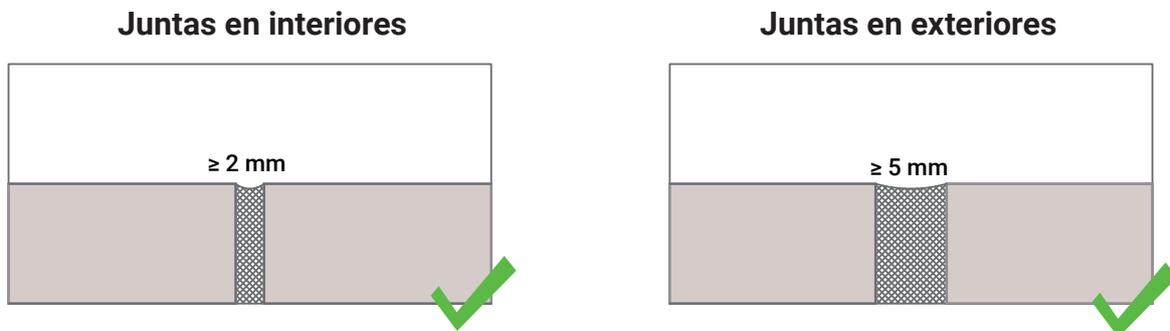
Lapitec SpA recomienda que se respete en todo momento una distancia mínima de 2 mm (independientemente de la naturaleza del soporte). No está permitida la instalación de "sin fugas". Para superficies expuestas a grandes oscilaciones de temperatura (por ejemplo, entradas entre zonas exteriores e interiores, zonas próximas a grandes ventanales, etc.), la junta mínima debe ser de 3 mm. En exteriores, la junta mínima permitida es de 5 mm.
