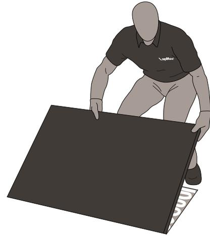
No se debe impedir la evaporación del agua de proceso y/o de los disolventes contenidos en los adhesivos mediante la colocación de lonas o protecciones de ningún tipo sobre los revestimientos, ya que los vapores podrían reaccionar con el plástico o el papel, perjudicando el buen resultado del trabajo.
