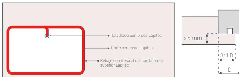
Se aconseja realizar el mecanizado al ras con la parte superior después de haber realizado el corte del fregadero. Además es conveniente prever que después del rebaje queden como mínimo 5 mm de grosor de material.
