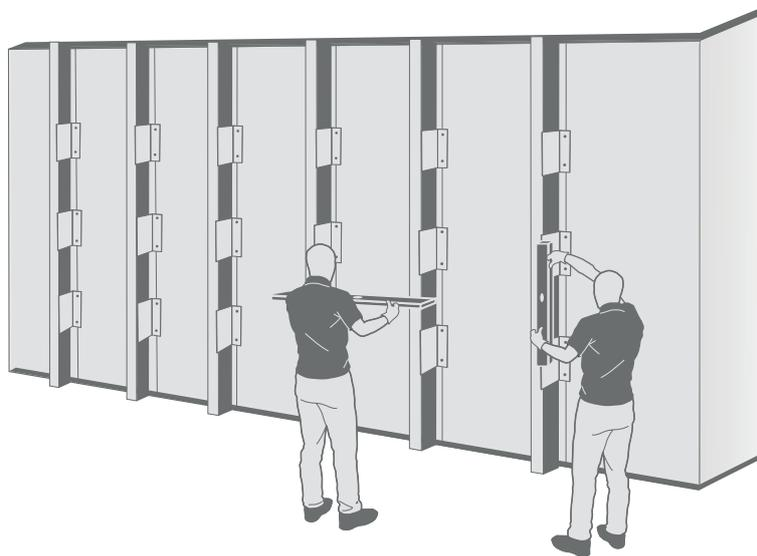
**Achtung:** Während der Montage muss der Monteur ständig darauf achten, dass die Unterkonstruktionen unter Beachtung der Ebenheit zwischen den Elementen installiert werden. Jede Verformung der Montageebene könnte die Montage der Platten beeinträchtigen, da es unmöglich wäre, die Platten zu montieren. Lapitec® ist ein steifes Material, das bei der Installation auf der Unterkonstruktion nicht gebogen oder gespannt werden kann.
