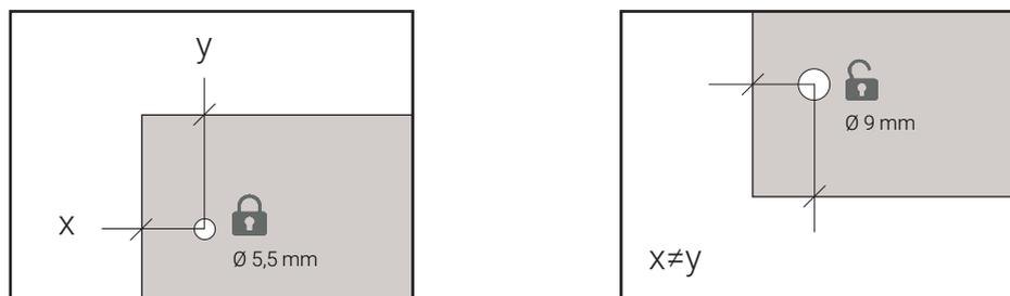
Die Durchgangsbohrungen für das Befestigungssystem mit Niet müssen unter Beachtung der folgenden Durchmesser ausgeführt werden: Ø 5,5 mm für Festpunkte und Ø 9 mm für Verschiebepunkte.
